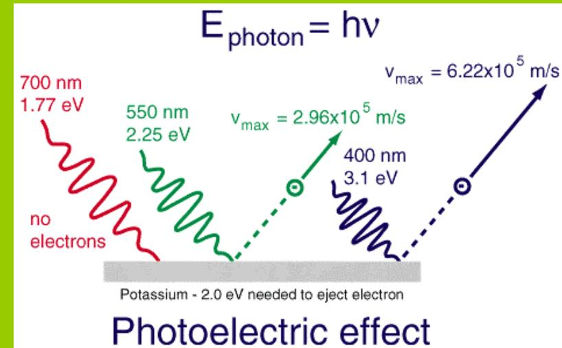
**Effetto fotoelettrico con radiazione visibile di diversa lunghezza d'onda:**
